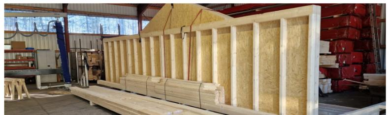
Ziel der Rohbauleistung ist, möglichst rasch den Wetterschutz herzustellen. Während die unteren Geschosse gemauert werden, kann das Dachgeschoss vorgefertigt werden.
